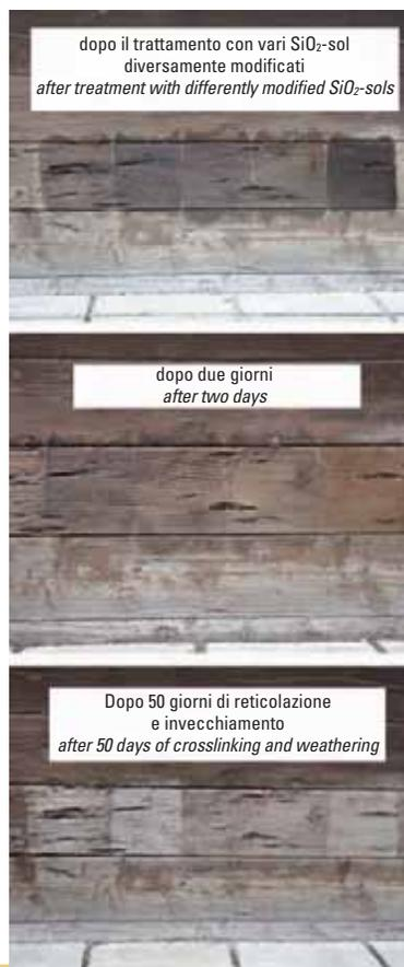
**Fig. 11** Muro di legno trattato con vari  $\text{SiO}_2$ -sol modificati. Immagini prese dopo aver applicato direttamente il prodotto, dopo l'essiccazione e l'invecchiamento. Wooden wall with differently modified  $\text{SiO}_2$ -sols presented directly after application and after drying and weathering
