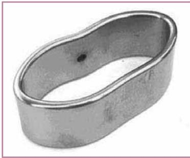
**Fig. 4 Test dell'anello d'acciaio con il rivestimento Hardide di 50 micron sollecitato per valutare l'adesione e la tenacità del coating. Nessuna delaminazione o separazione del coating dal substrato**
