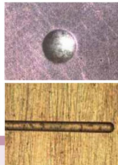
**Fig. 3** Microfotografie di un'incisione dal diametro di 1 mm (sopra) e test della scalfittura di un coating Hardide-T con spessore di 50 micron su acciaio. Assenza di screpolature e frammenti per un'alta tenacità
