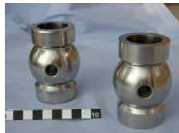
**Fig. 7** Valvole a sfera rivestite con Hardide
