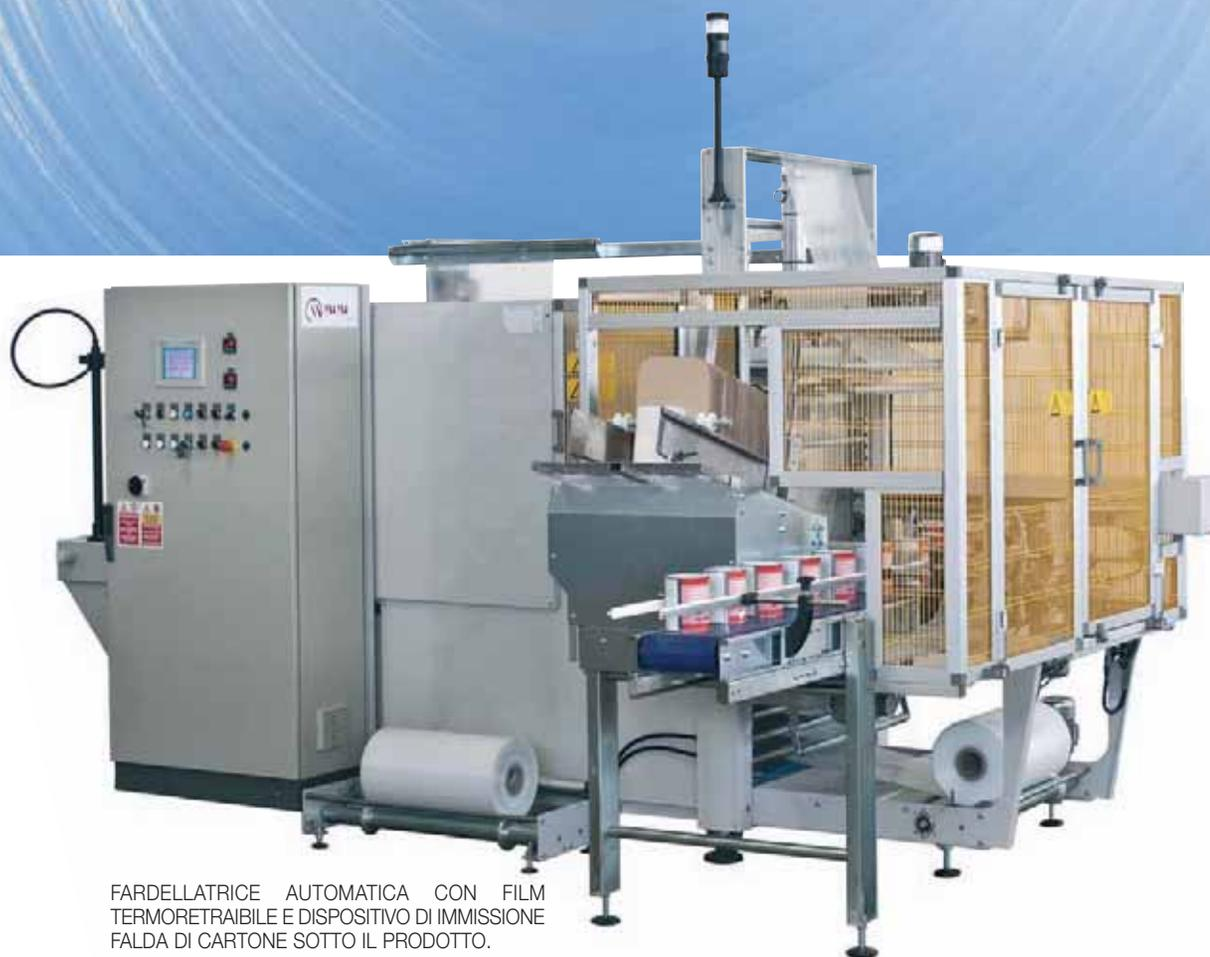
FARDELLATRICE AUTOMATICA CON FILM TERMORETRAIBILE E DISPOSITIVO DI IMMISSIONE FALDA DI CARTONE SOTTO IL PRODOTTO.
