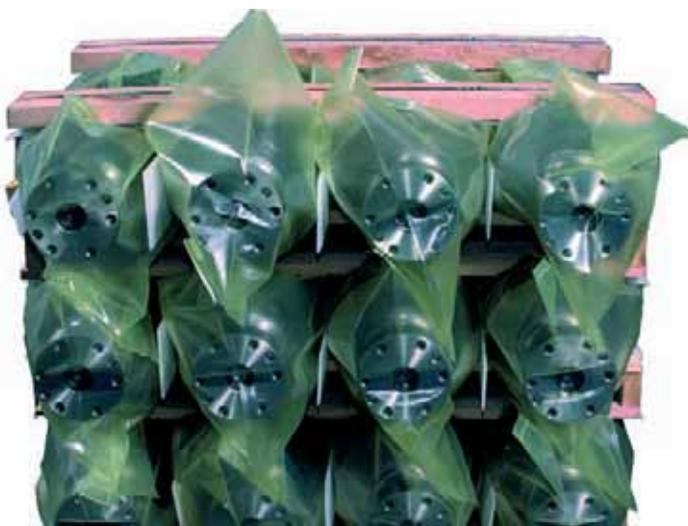
I cosiddetti imballaggi VCI (inibitori di corrosione volatili) creano un'atmosfera anticorrosiva all'interno della confezione. Nello stesso tempo, il materiale d'imballaggio fornisce protezione dalla contaminazione dall'esterno
