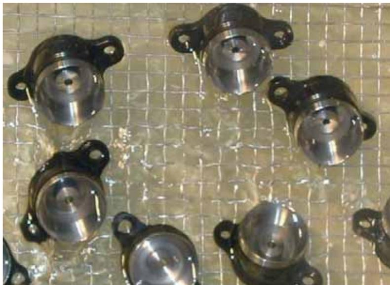
**I manufatti sono protetti dal processo corrosivo durante il processo di pulitura con gli additivi contenuti nell'agente detergente utilizzato**
