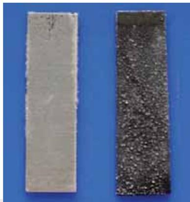
**Fig. 7** Test della corrosione a lungo termine: lega di alluminio rivestita con coating polielettrolitico/inibitore (a sinistra) e lastra di alluminio non modificata (a destra)
