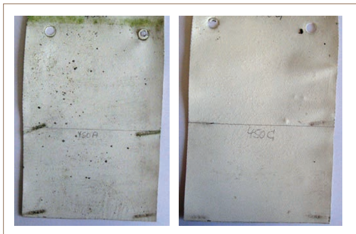
Fig. 5 Outdoor weathered panels of styrene acrylic coatings in Germany (N51°2 24, E7°5 43) Exposure time two years. Left coating – unpreserved control, right coating – 1.5% Preventol next ® A 31-D Pannelli segnati dalle intemperie in ambiente esterno con vernici acriliche stirene, in Germania (N 51 °2 24, e7 °5 43), 2 anni di esposizione. La vernice a sinistra, senza preservante, la vernice di destra con l'1,5% di Preventol next ® A 31-D
