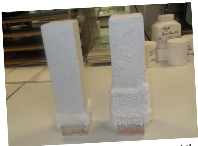
Test on primer based on OMNOVA resins superior resistance on alkali and efflorescence / Test su primer con resine Omnova. Resistenza superiore agli alcali ed efflorescenza
