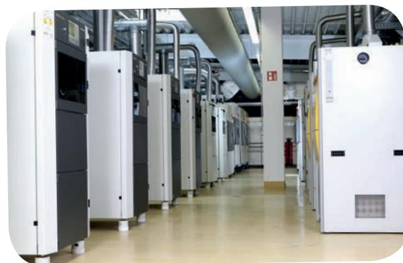
*Atlas Material Testing Technology, leader mondiale per le soluzioni nel campo dei test sulla durabilità dei materiali, ha presentato uno strumento rivoluzionario per la misura e il controllo di tutti i principali parametri dell'invecchiamento atmosferico in laboratorio, il Sensore-All-In-One (AIOS). Questo sensore è montato sul supporto della serie Ci di Weather-Ometer®, che misura l'irraggiamento continuamente e simultaneamente,*
