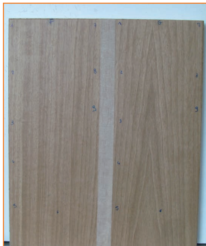
Fig. 1-2 Si riportano le fotografie (1 e 2) di pannelli di legno trattati con le formulazioni sopra descritte e poi sottoposti ai test di resistenza chimica
