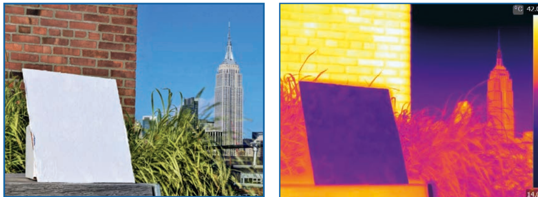
Fig. 1 Quando il rivestimento polimerico poroso è esposto all'atmosfera, esso riflette i raggi solari ed emette calore fornendo così temperature più fresche nell'aria e nell'ambiente di quelle ottenibili con i materiali da costruzione tipici
