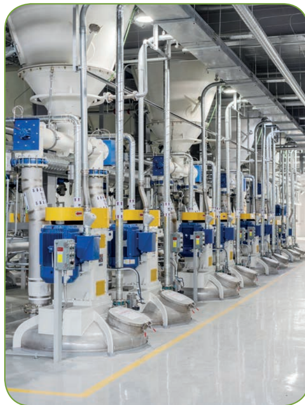
Unità disperdenti con dispersori autopulenti a doppia asse
