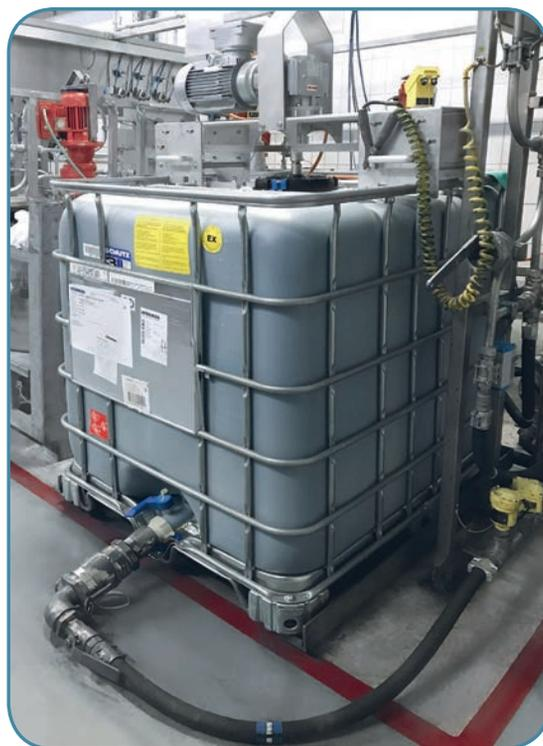
Collegamento diretto alla linea di produzione dell'IBC completo di Impeller e sistema di propulsione del miscelatore con raccordo Camlock da 2"
