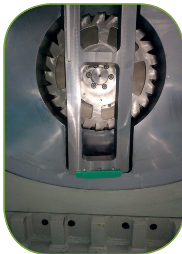
Dettaglio degli utensili nelle cave sul telaio superiore a fine miscelazione
