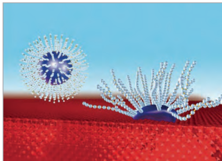
Fig. 3 Schematic representation of a star-shaped dispersant Rappresentazione schematica di un disperdente a forma di stella
