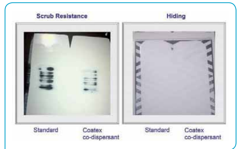
Fig. 11 Evolution of scrub resistance and hiding power after the reformulation Evoluzione della resistenza allo sfregamento e potere coprente dopo la riformulazione
