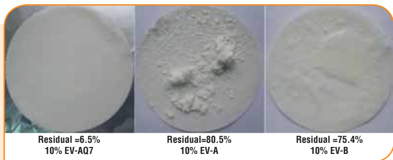
Fig. 2 Photos of 10% different types of light stabilizers in waterborne UV curable coating is filtrated tested Foto del 10% di tipologie differenti di stabilizzanti per rivestimento a base acquosa reticolabile a UV testato
