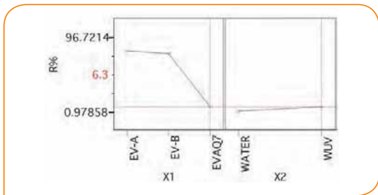
Fig. 1 The effect of different types of light stabilizers in waterborne UV curable coating is filtrated tested (Prediction Profiler) L'effetto di diverse tipologie di fotostabilizzanti nel rivestimento a base acquosa reticolato a UV testato (profilo previsioni)
