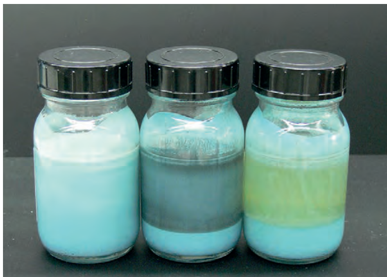
Fig. 4 Paints after aging for 2 weeks at 50 °C, left: TEGO® Dispers 678 Vernici dopo invecchiamento di 2 settimane a 50 °C, a sinistra: TEGO® Dispers 678
