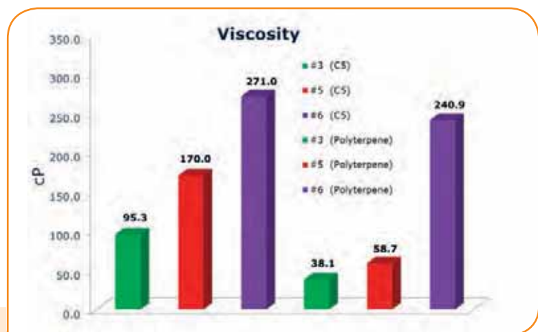
Fig. 3 The effect of molecular weight on viscosity Effetto del peso molecolare sulla viscosità
