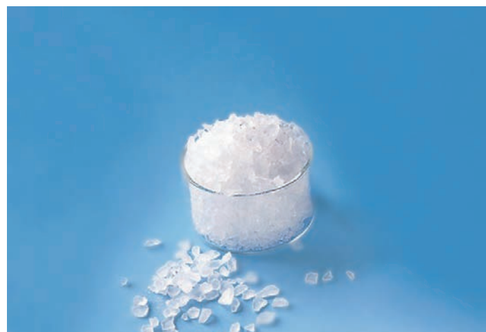
Fig. 2 Silicone resins are highly crosslinked. They have a naturally brittle consistency Le resine silconiche sono altamente reticolate. La loro consistenza, per natura, è fragile
