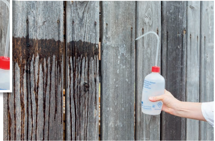
Fig. 6 Passing the weathering test: even after 17 years of outdoor weathering, wood treated with the silicone resin is still water repellent. This affords a way of reliably protecting wood against moisture and wet for many years Test di esposizione agli agenti atmosferici superato. Anche dopo 17 anni di esposizione all'aperto, l'effetto idrorepellente della resina siliconica è intatto. Questo metodo permette di proteggere il legno in maniera affidabile per tanti anni dall'umidità e dall'acqua
