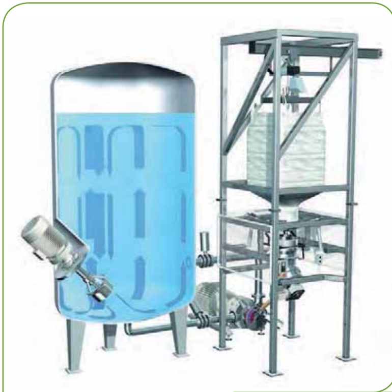
Conti-TDS powder wetting module using a JetStream mixer and powder induction from big-bag unloading station Modulo per bagnatura polveri Conti-TDS con miscelatore JetStream e induzione polveri da stazione di svuotamento sacconi
