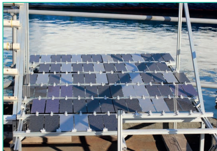
Fig. 4 Campioni aventi forma e dimensioni standard esposti in differente condizione di inclinazione rispetto alle normative (5 gradi rispetto all'orizzontale), fissati sulle strutture espositive modulari di recente costruzione
