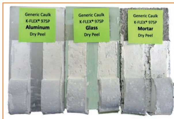
Fig. 4 K-Flex 975P testato in un prodotto per calafataggio da ASTM C920 nel confronto con i substrati di alluminio, vetro e malta
