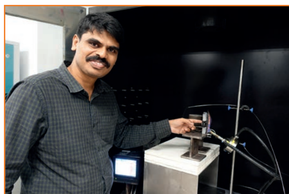
Fig. 2 Aravind Dasari Professore Assistente dell'NTU mette il dito su un pezzo di plastica abbastanza freddo da essere toccato che è stato posto dietro una piastra in acciaio rivestita con FiroShield ed esposta a una fiamma di oltre 900 gradi Celsius
