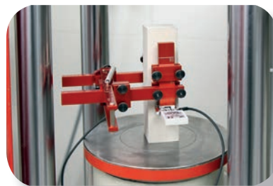
Fig. 1- Test specimen prepared for the Young's modulus measurement Campione preparato per la misurazione del modulo di Young
