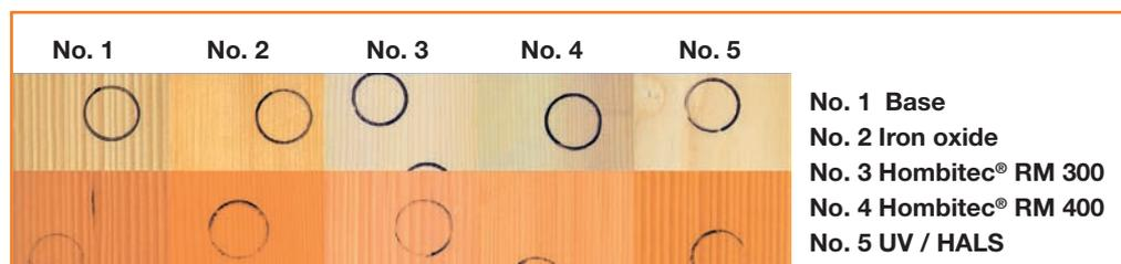
**Fig. 1 After 1000 hours artificial weathering / Dopo 1000 ore di erosione causata da agenti atmosferici artificiali**
