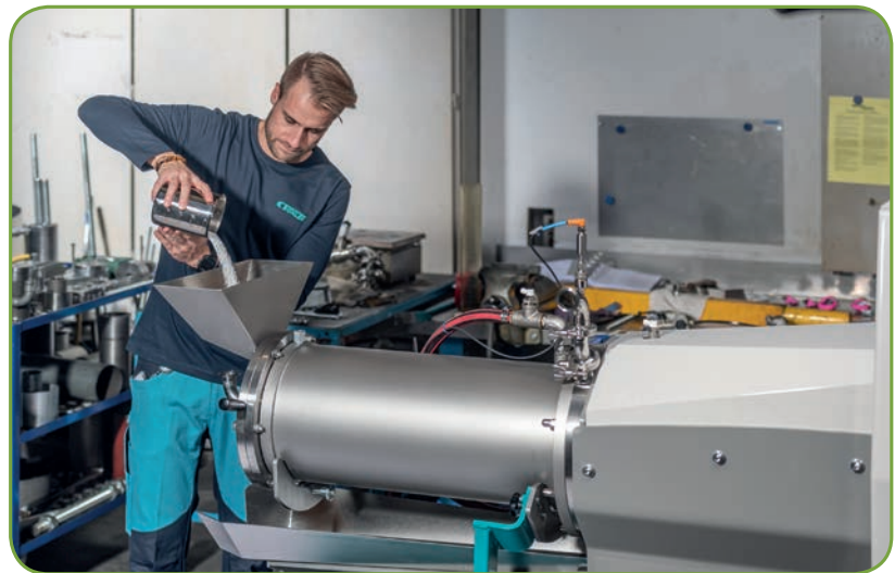
Fig. 1 - La camera di processo del Visconomic+™ si trova ad un'altezza ideale per l'operatore
