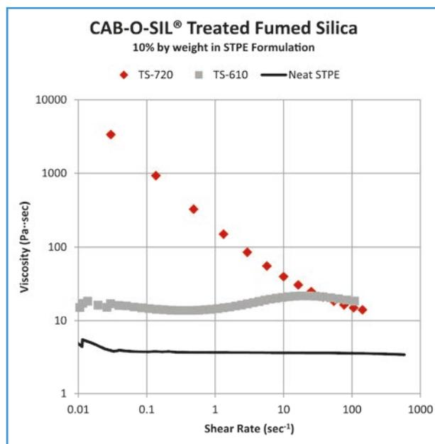
Fig. 1 Viscosità in funzione della forza di taglio di STPE non reticolati, misurata con reometro a sollecitazione controllata
