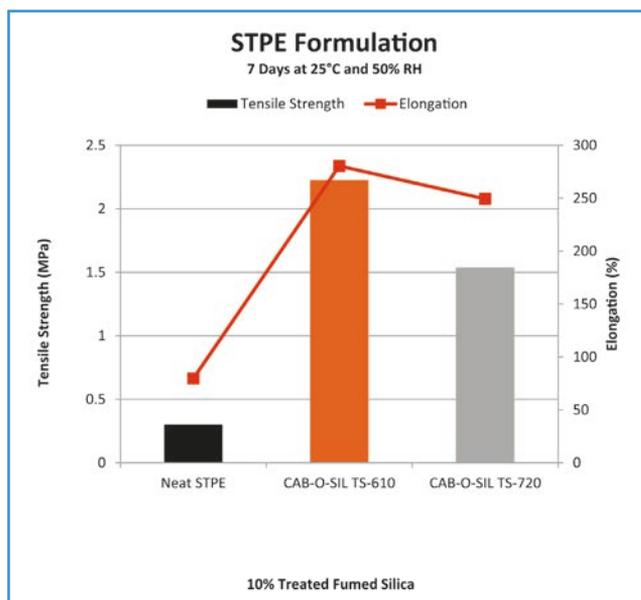
Fig. 2 Resistenza alla trazione e allungamento a rottura di STPE reticolati
