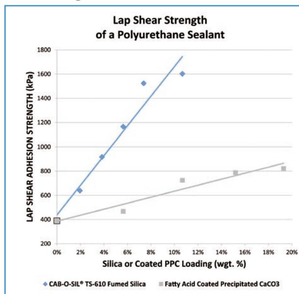
**Fig. 3 Resistenza allo scorrimento di elementi sovrapposti di un adesivo poliuretano su substrato in alluminio**
