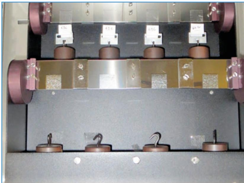
**Fig. 4 Forno per test della resistenza allo scorrimento a due piani e con otto posizioni. Piano superiore: l'adesivo pressosensibile con dispersioni di rinforzo Cab-o-sperse mantiene il legame con le forze di taglio applicate. Piano inferiore: l'adesivo pressosensibile privo di rinforzo entra in uno stato di degradazione (si osservi che la degradazione coesiva lascia il film sul supporto aderente di acciaio inossidabile)**
