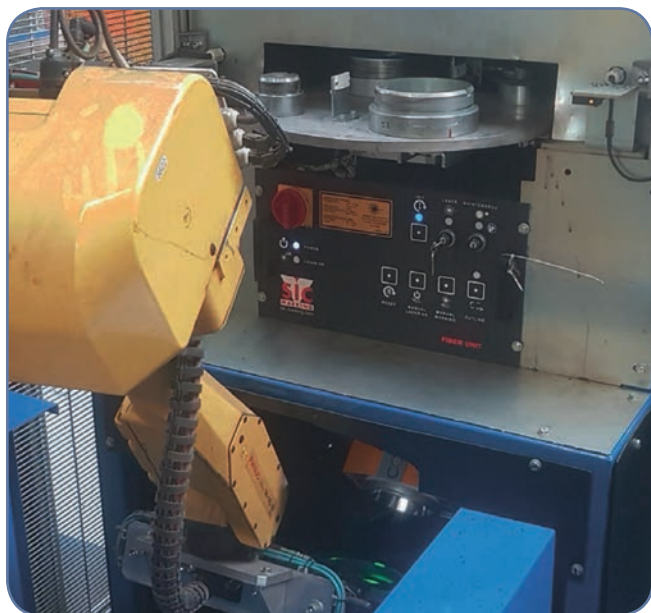
Fig. 2 - Da AAM Lyon ogni smorzatore di vibrazioni torsionale prodotto viene misurato con il coatmaster. Lo spessore dello strato e altri parametri di produzione sono riportati nel codice QR mediante marcatura laser
