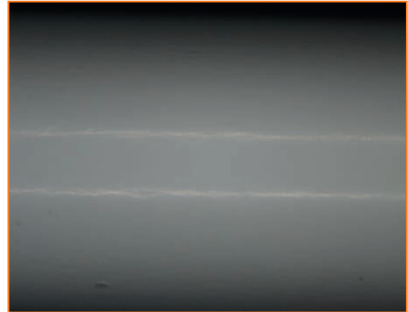
Fig. 4 Immagini al microscopio ottico (40 \times oom) delle finiture bianche Zeffle GK soggette alla flessione 1T in base ad ASTM D4145
