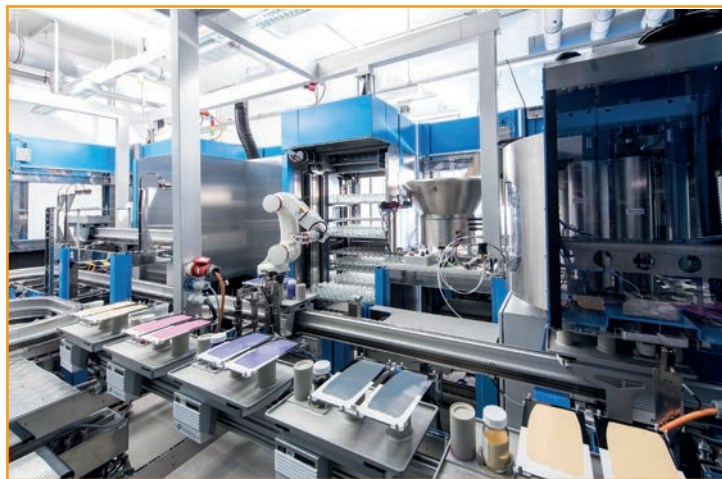
Fig. 1 Il circuito di prova per le vernici (HTE): con il suo sistema completamente automatizzato di test di composizione della vernice, Evonik riduce progressivamente il tempo necessario per trovare la formulazione ottimale. Oltre 100 campioni possono essere testati sul sistema nell'arco di 24 ore
