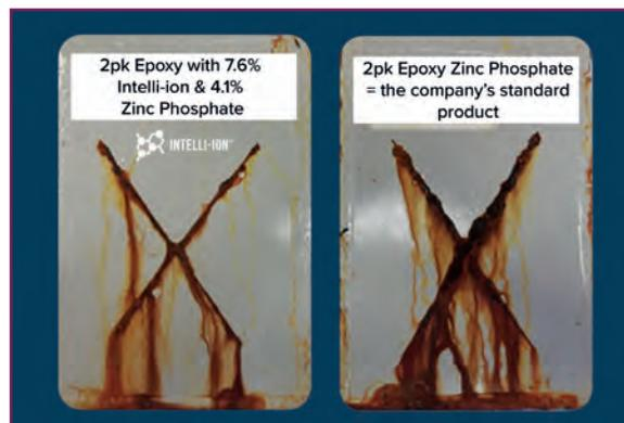
**Fig. 2 Further results from marine paints manufacturer, Teamac, following 750 hours accelerated weathering (ASTM B117) / Risultati forniti da un produttore di pitture per uso nautico, Teamac, dopo l'esposizione per 750 ore al test dell'invecchiamento accelerato (ASTM B117)**
