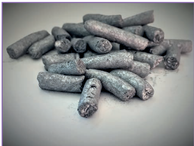
Fig. 1 Figure of pelletized aluminum used as the subject of this study Immagine dell'alluminio in granuli sferici utilizzati per compiere questo studio
