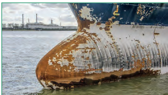
Fig. 1 Ships have to be overhauled regularly, as wind and waves abrade the paint. Together with the flakes, microplastic particles also end up in the sea. Photo: istock/franswillemblok Le navi devono essere revisionate regolarmente perché il vento e le onde corrodono la pittura. Insieme alle scaglie, le particelle di microplastiche confluiscono nelle acque del mare. Foto: istock/franswillemblok
