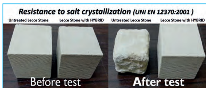
Fig. 3 Hybrid's efficacy to salt crystallization L'efficacia di Hybrid alla cristallizzazione di sali
