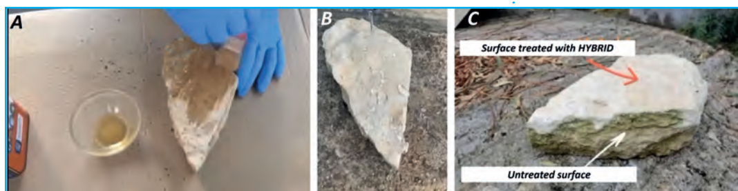
Fig. 5 Application (A), hydrophobicity (B) and weathering resistance (C) of natural stone treated with the coating Applicazione (A), idrofobicità (B) e resistenza agli agenti atmosferici (C) della pietra naturale trattata con il rivestimento
