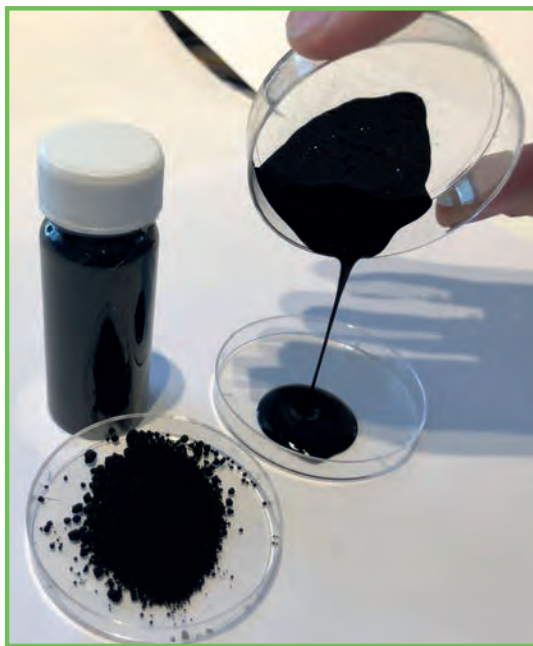
Fig. 1 Dispersion of special carbon black prepared with LigniOx dispersant Dispersione del carbon black speciale preparata con LigniOx
