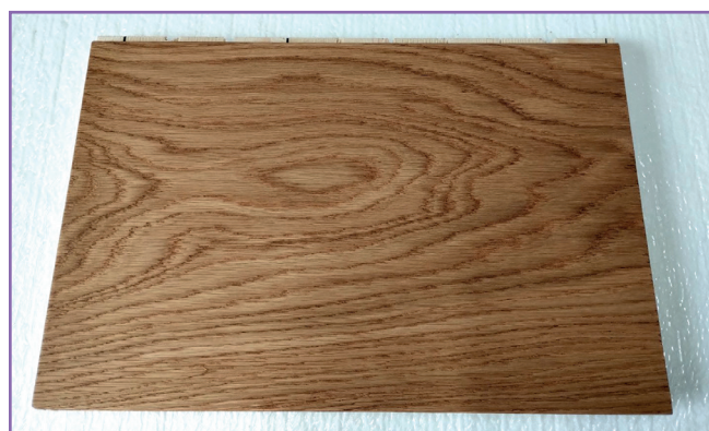
Fig. 1 - The protein/additive combination, applied to the surface of oak flooring with an oil-based topcoat Combinazione proteina/additivo, applicata alla superficie di un pavimento in legno di quercia con finitura a base oleosa
