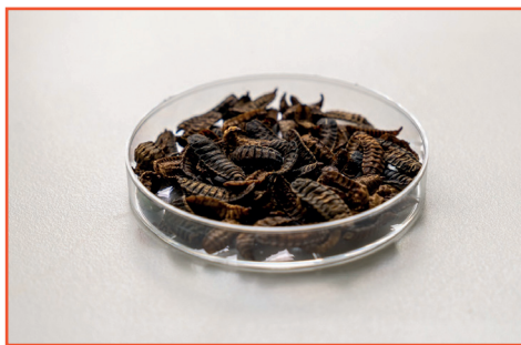
Fig. 1 - Insect exuviae are another source of raw material for chitin, alongside crab shells Le esuvie sono un'altra materia prima da cui ricavare chitina, insieme ai gusci di granchi
