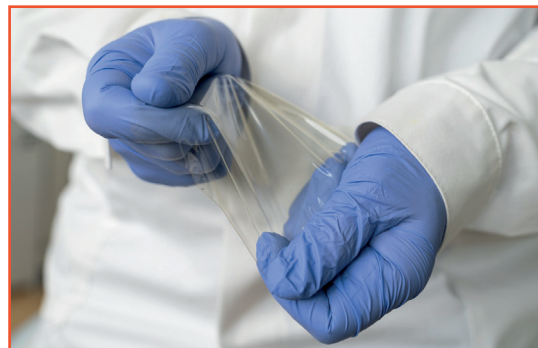
Fig. 3 - Chitosan films are well-suited for packaging applications due to their balanced elasticity and transparency I film di chitosano sono adatti ad applicazioni di imballaggi per la loro elasticità e trasparenza bilanciata
